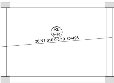
Armação positiva da laje R6 (Eixo X)
